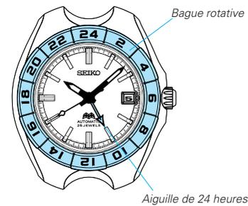
Vérifiez que le chiffre "24" sur la bague rotative se trouve à la position 12 heures.
